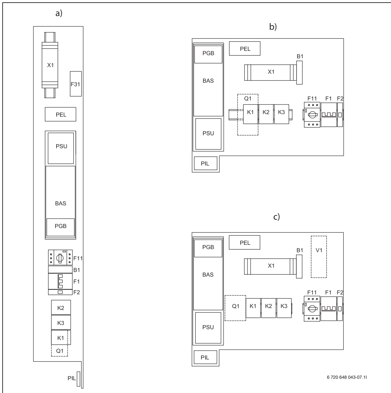
Obr. 39 Přehled obvodových desek
